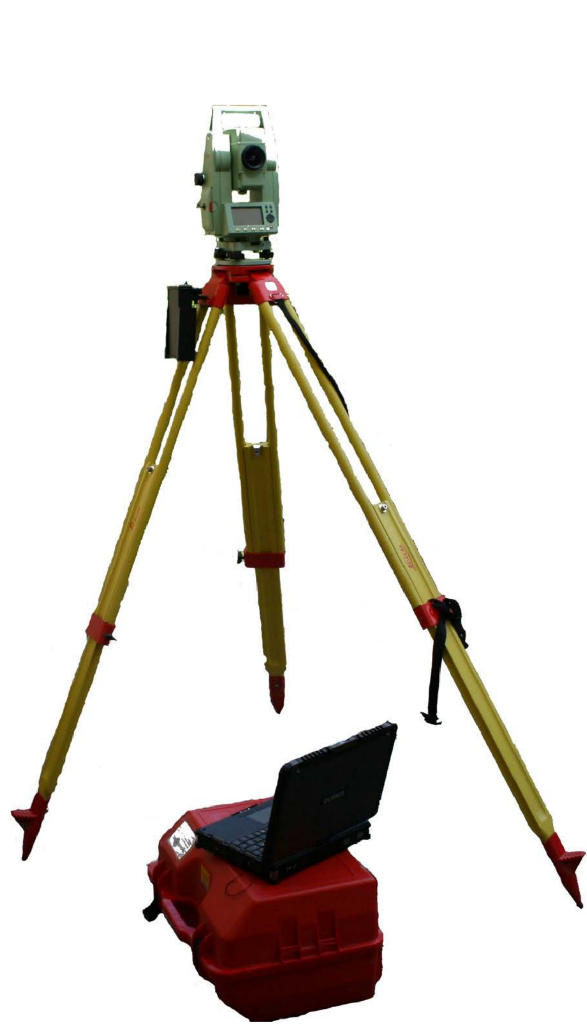
Totalstation mit drahtloser Verbindung zur Steuerungssoftware
