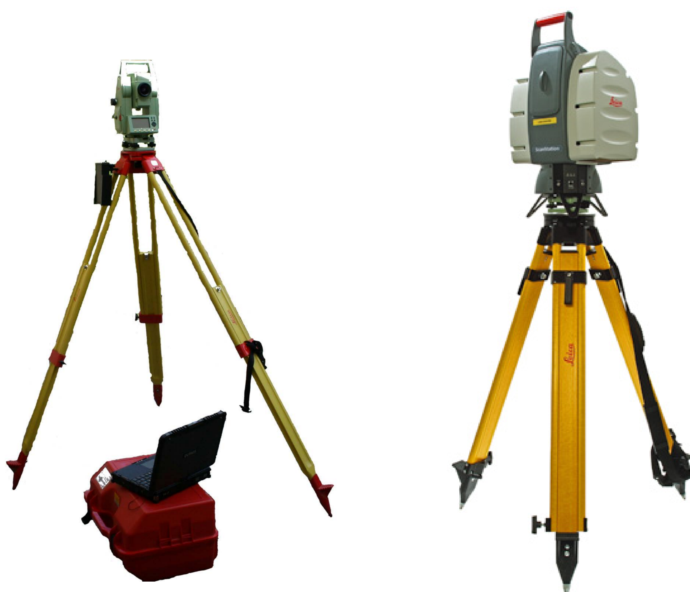
Totalstation mit drahtloser Verbindung zur Steuerungssoftware
